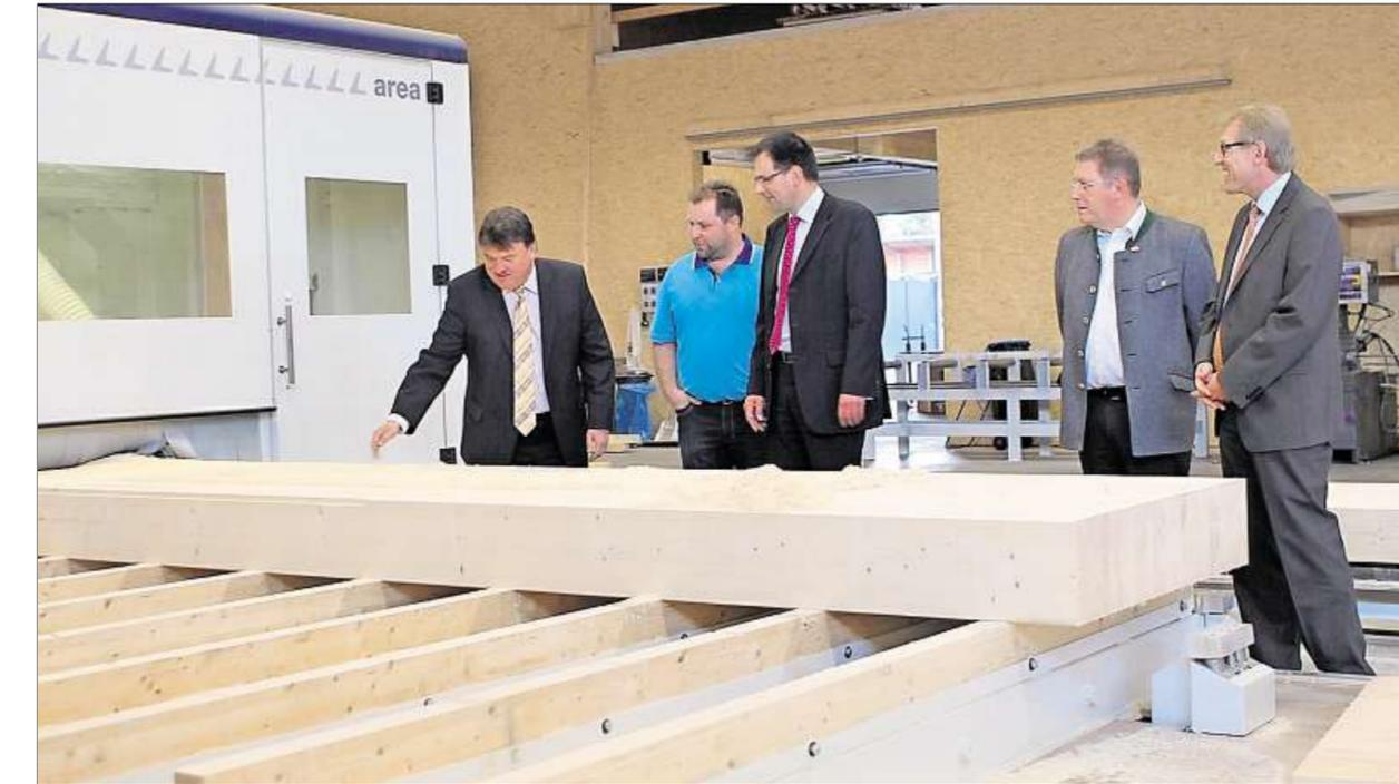
Modernste CNC-Technik wird in der Firma Fleischmann Holzbau eingesetzt. Der Koloss, in den schalldämmende Rillen gefräst werden, wird einmal eine Zwi-scherendecke in einem Gebäude. Landrat Klaus Peter Söllner (von links), Firmeneinhaber Harald Fleischmann, Landtagsabgeordneter Martin Schöffel, Oberbürgermeister Henry Schramm und der Chef der Arbeitsagentur, Sebastian Peine, betrachten fasziniert diesen hochpräzisen Arbeitsprozess. Fotos: Burger
